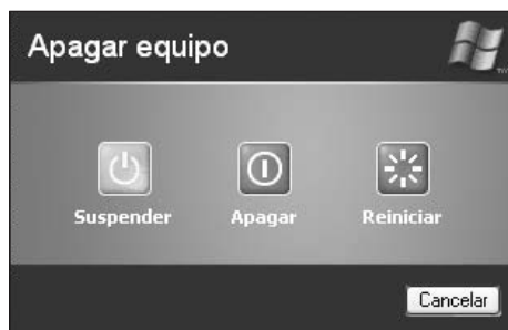
Figura 29. Luego de aplicar la política, al apagar la computadora, tendremos el cuadro de diálogo clásico aun habiendo actualizaciones por instalar.
