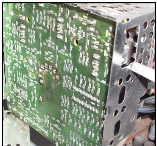
LAS SOLDADURAS DE LOS CONTACTOS DEL ZOCALO SUELEN SER VICTIMAS CONSTANTES DEL PASO DE LA CORRIENTE. ANTE LA DUDA, SIEMPRE ES RECOMENDABLE REPASAR CADA UNA DE ELLAS USANDO SOLDADOR Y ESTAÑO.
