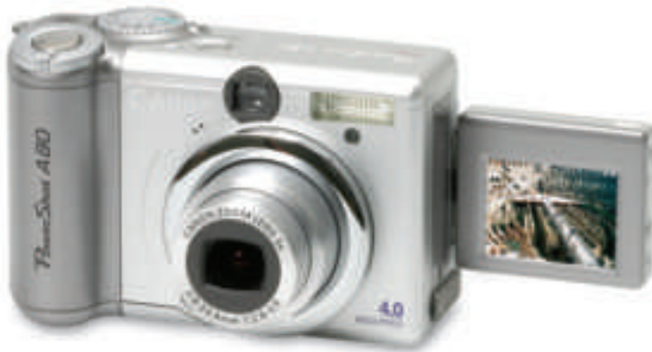
Figura 32. La Canon Powershot A80 tiene una pantalla de LCD que puede rotarse en cualquier dirección.
