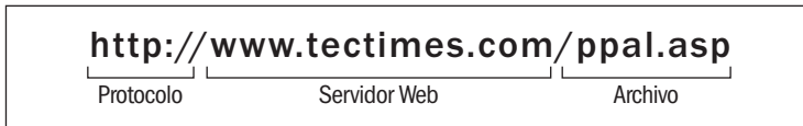
Figura 6. Cuando solicitamos una página web, le estamos pidiendo al servidor que es parte del dominio de la URL que nos entregue el archivo indicado luego de la barra (/). Si no referimos un archivo, nos traerá el predeterminado.
